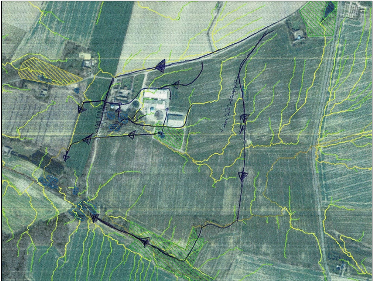
Figur 10 Kort med ansøgers håndtegning af drænforhold i området omkring Lillegård. På kortet ses også naturlige strømningsveje i landskabet (som dog ikke tager højde for de aktuelle drænforhold). Endvidere ses med skravering en vejledende registrering af § 3-beskyttet natur, som dog siden er blevet ændret og opdateret.
